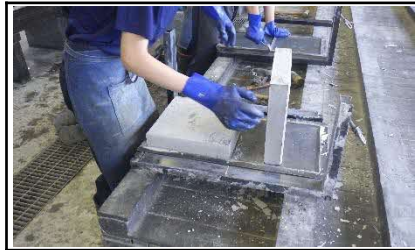
工業科：歩道平板の製造
