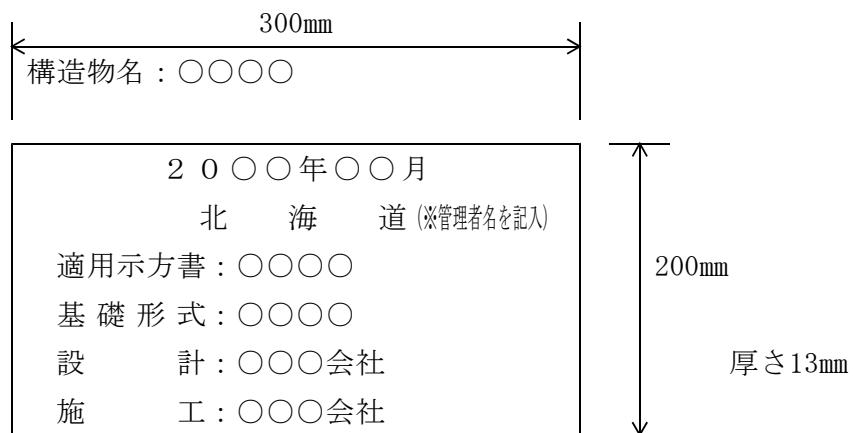
図2－2 構造物履歴板
