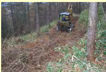
伐採時に伐り落とした枝や葉を集材路に敷き込んでいる様子
