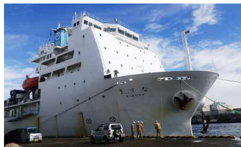
↑ 写真2 海底ケーブル敷設船
