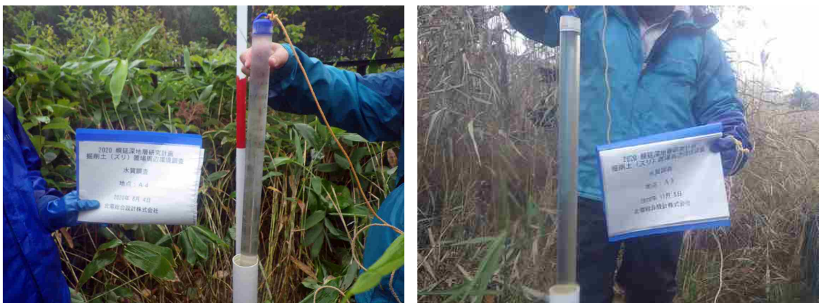
図 110 掘削土（ズリ）置場周辺の地下水の採水状況（A1～A4）
