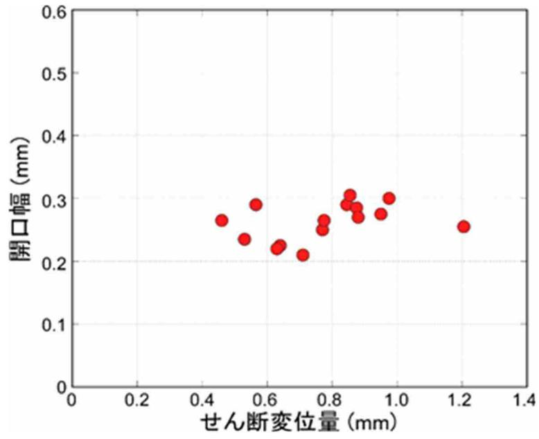
図 70 EDZの割れ目で計測された開口幅とせん断変位量の関係
