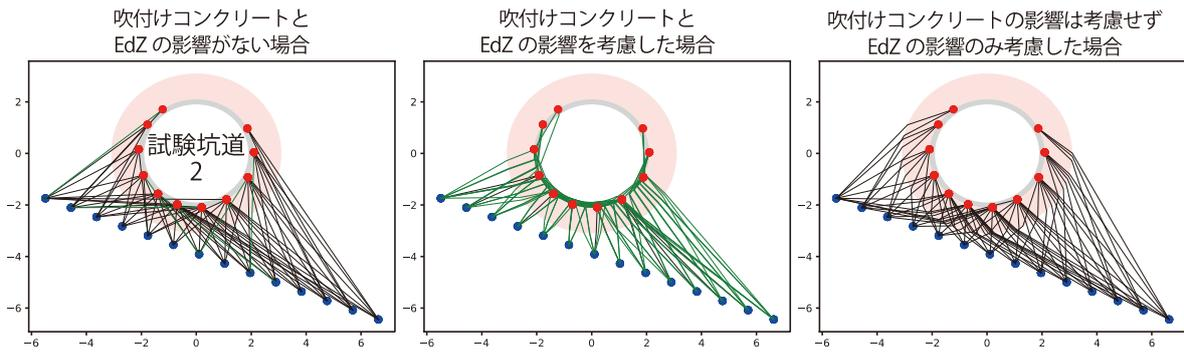
図 46 数値シミュレーションによる調査時の弾性波の通過経路の比較例
