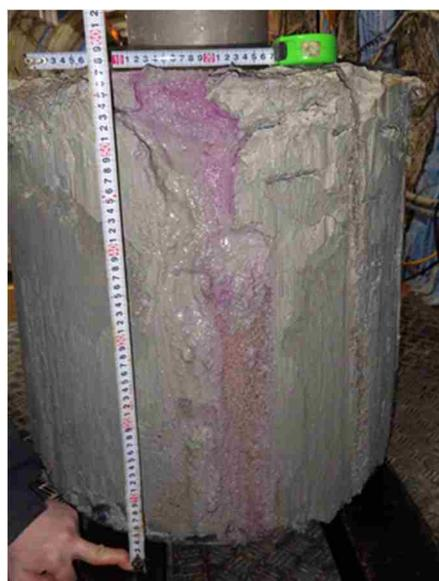
図 51 緩衝材流出試験後に回収した試験体
