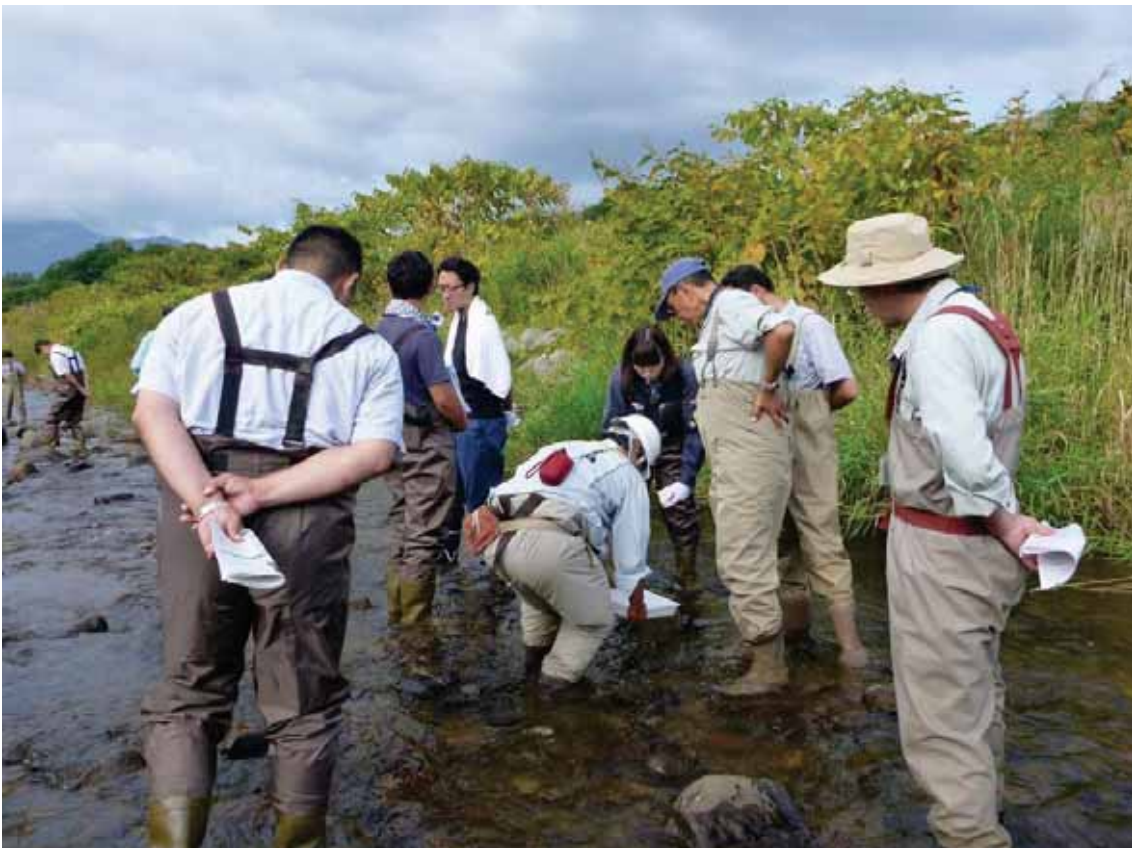
写真 3-23 ルベシベ川(ニセコ町) 建設管理部職員と有識者による河川整備後の 河床材料のモニタリング(河川環境研究会)
