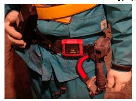
オ)メタンガス検知器 (携帯用) 固定の検知器以外に、作業員に常備させ ている。
