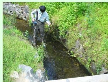
図 5-2 電磁流速計での流速測定
