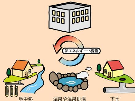
温泉の排湯、地中、下水などが持つ熱エネルギーを回収し、利用します。
