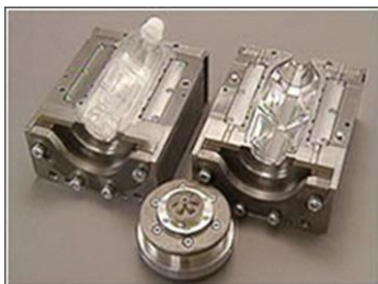
ペットボトルを成形するための金型
