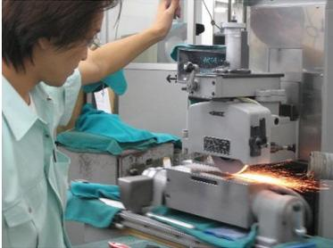
多種形状を1~2μmの精度で仕上げることが可能
