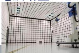
機器の電磁ノイズ発生量や、電磁ノイズに対する耐性を評価
