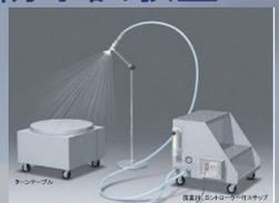
風雨にさらされる電子部品や、水を使う食品加工機械などの防水性を評価
