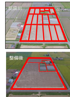
基盤整備による ほ場の大区画化
