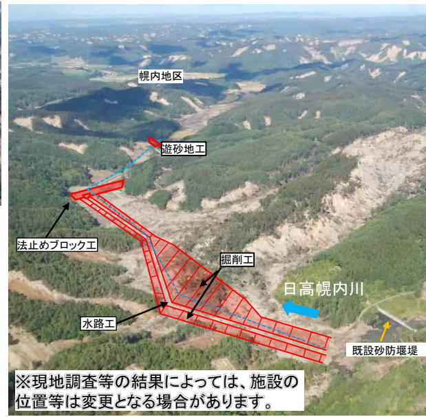
日高幌内川の河道閉塞状況及び対策イメージ
