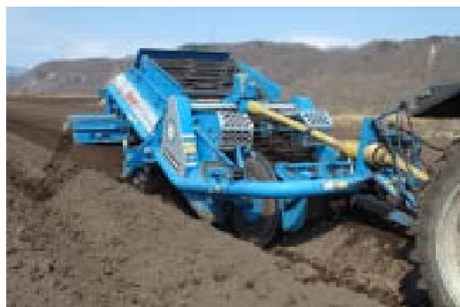
写真2 セパレータによる石と土塊の除去作業
