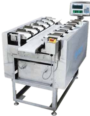
半自動組合せ計量機 データウェイTSDW
