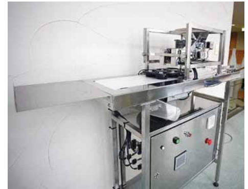
食品、菓子のトッピング装置 (主な材質) ステンレス (特徴・用途) 自動化することにより人員の削減。
