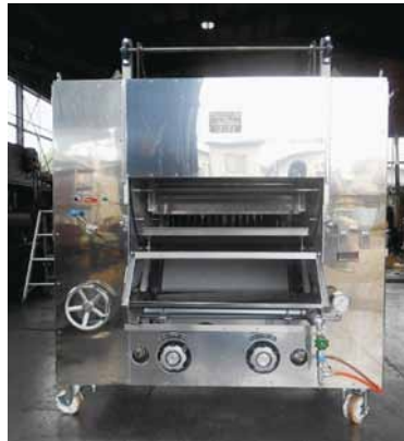
6本、12本焼きバームオープン (主な材質) ステンレス (サイズ) 1,620×1,220×1,650 (特徴・用途) 大量生産に対応。
