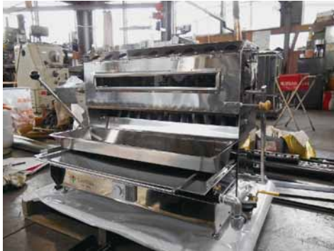
卓上式バームクーヘンオープン (主な材質) ステンレス (サイズ) 1,000×600×700 (特徴・用途) 持ち運び可能なオープン。 イベント等で使用可能。
