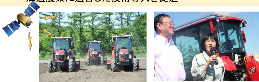
北海道大学で開発中のロボットトラクター3台協調作業(監視1名) (高精度GPSを活用し互いの位置や情報を共有して安全に作業)
