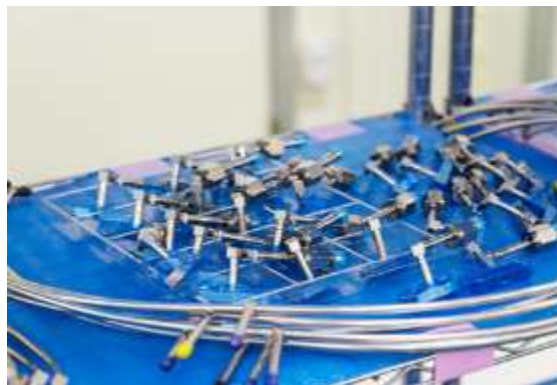
半導体製造装置の精密配管 出典) (株)テクノウェル ホームページ
