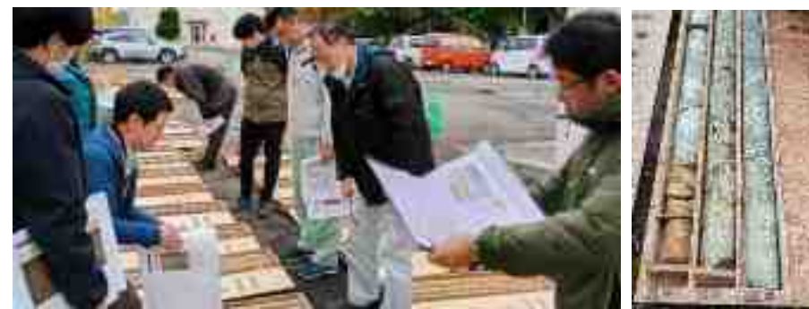
手稲山で採取したコアの観察による鉍化変質帯の調査(10月24日)
