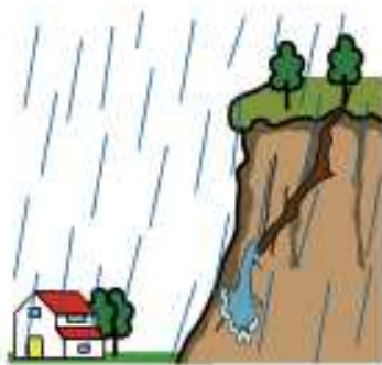
斜面から水の噴出し
