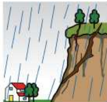
斜面のひび割れ
