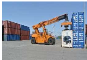
荷役作業車 （リーチスタッカー）
