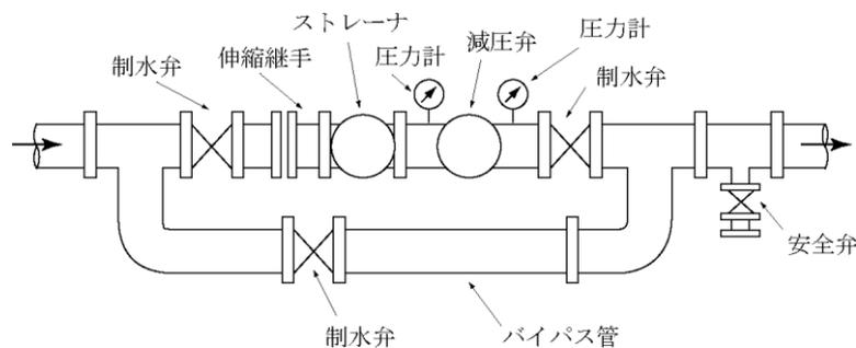
図-2.9.2 減圧弁周辺の標準的な配管
