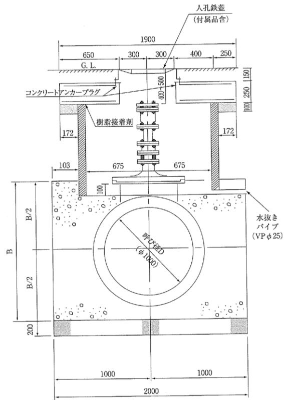
図-2.9.1 空気弁の例 (急速空気弁)
