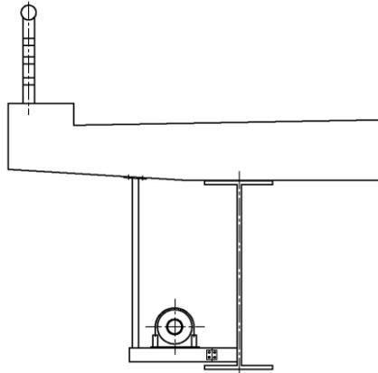
図-2.9.6 床版下吊下タイプ断面図（例）
