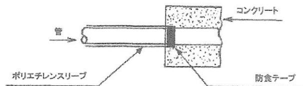
図-2.6.10 ダクタイル鋳鉄管の末端処理
