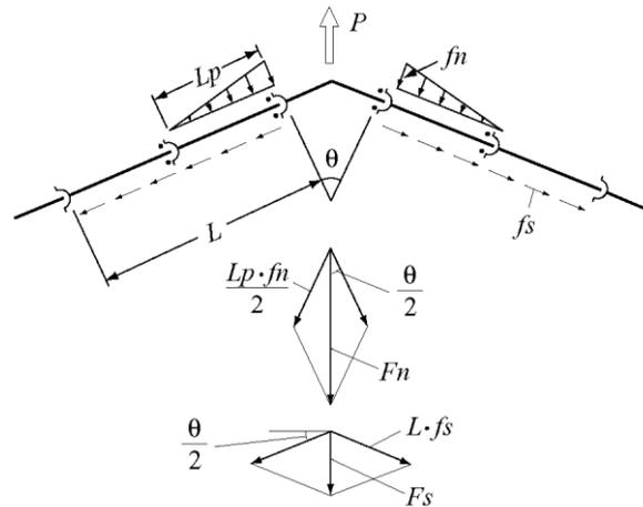
図-2.7.2 水平曲管に使用する場合
