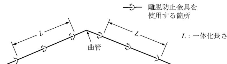
図-2.7.1 離脱防止金具の使用箇所
