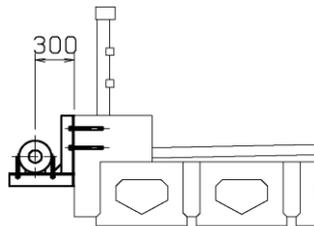
図-2.9.7 地覆側面固定タイプ断面図（例）
