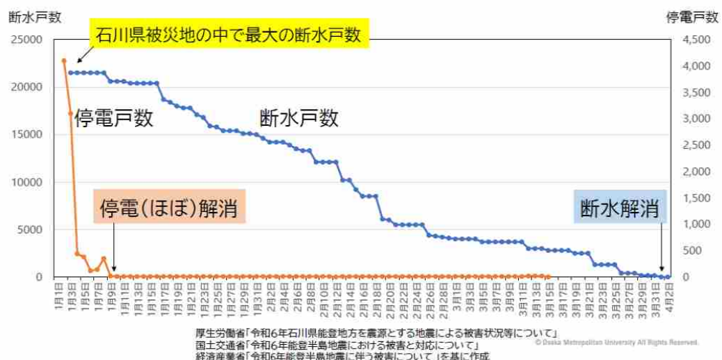
図2-4 七尾市における停電と断水のギャップ期間([6]より引用)
