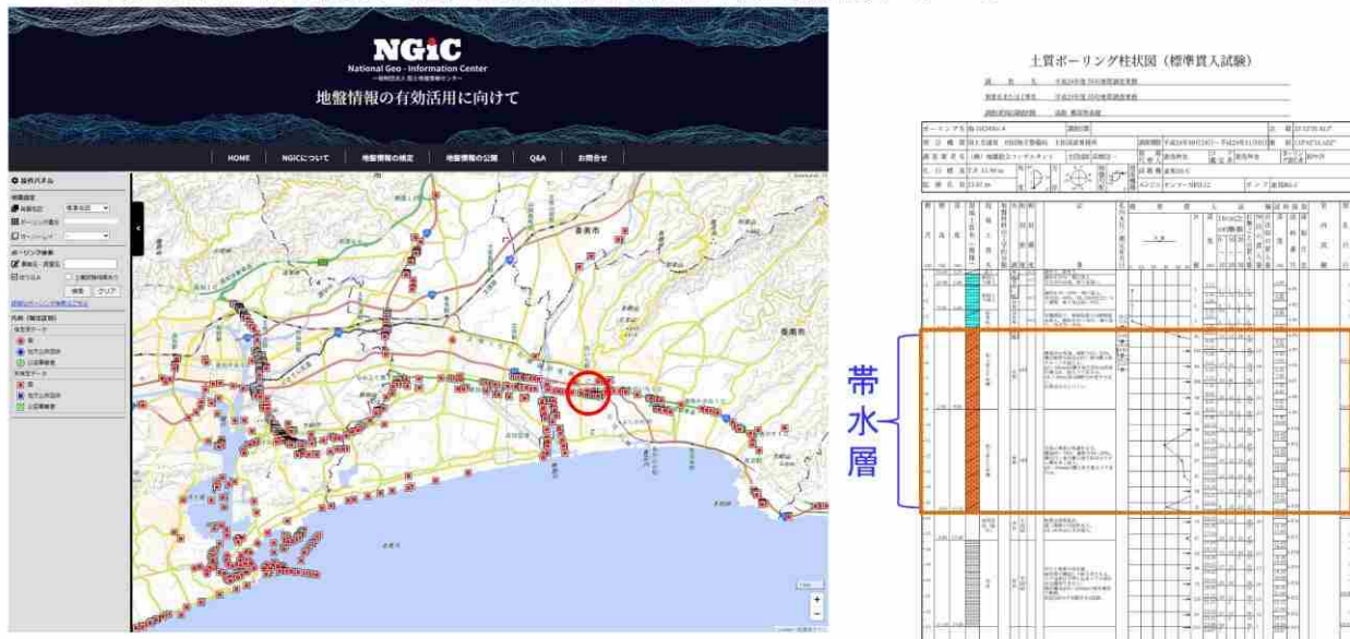
国・地方公共団体等が把握している柱状図(地質情報)の公表事例：国土地盤情報データベース
