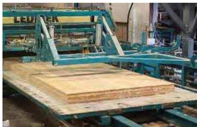
CLT 生産施設 (プレス)
