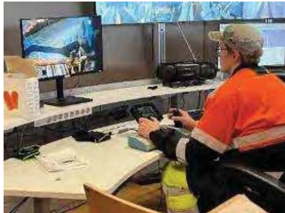
原木投入口でトラブルあった時には、遠隔操作グラップルで作業
