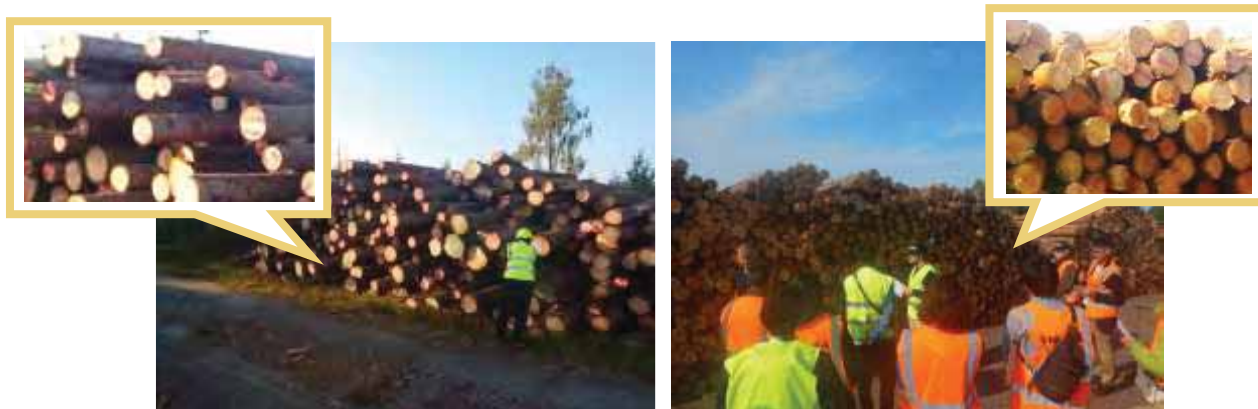
写真 2-1-1 ICTハーベスタによるカラーマーキング材(フィンランド土場、製材工場)
