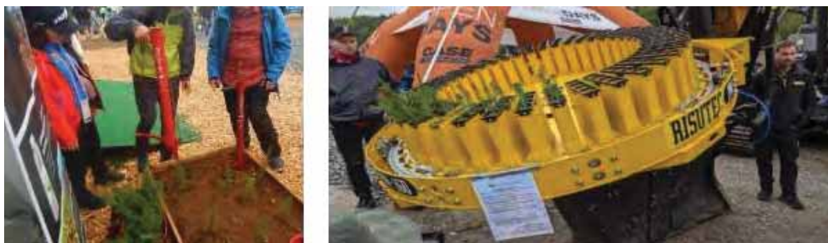
写真 2-3-1 コンテナ苗植栽器具と植栽アタッチメント in Finn METKO
