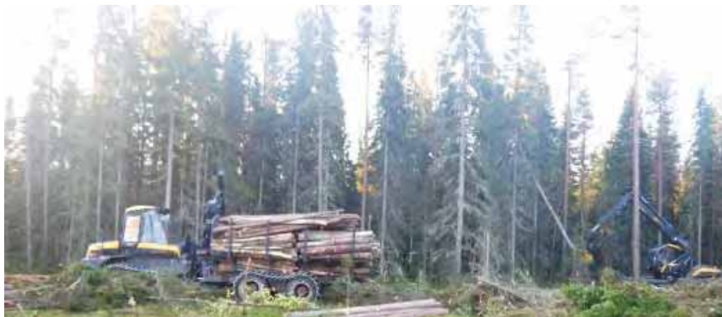
写真1-4-7 ハーベスタ・フォワーダシステムの様子（左がフォワーダ、右にハーベスタ。独立作業）
