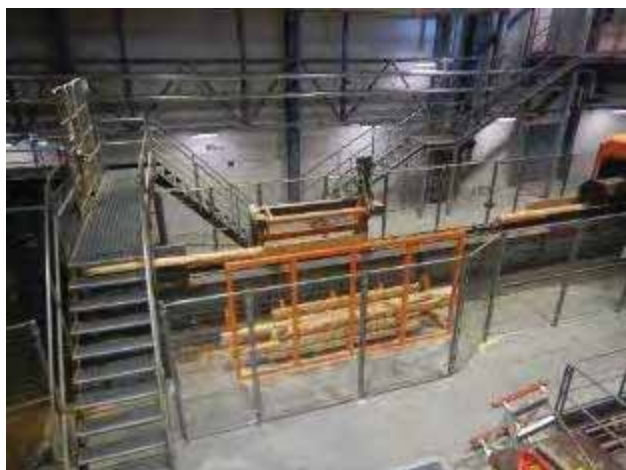
写真 1-7-9 大規模製材工場の高速度ライン(180m/分)
