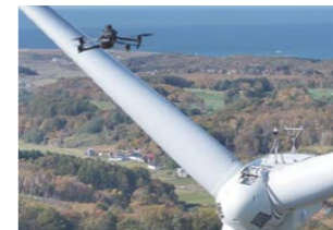
風車を点検するドローン
