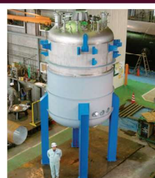
【培養槽（ジャケット付、内面#300研磨）】
