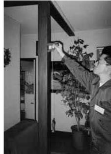
写真2-9 下げ振りによる傾斜の測定
