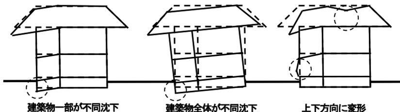
図 2-1 木造建築物の不同沈下
