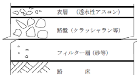
（透水性アスファルト舗装の構成例）
