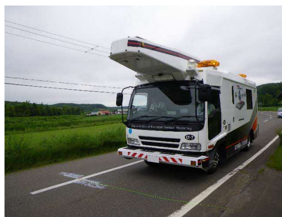
機器による路面性状点検例（路面性状測定車）
