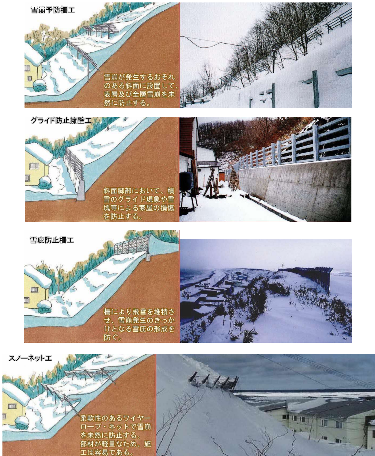
図 2-5 北海道が管理する雪崩防止施設
