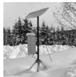
衛星通信サービス実証のためのアンテナ仮設
