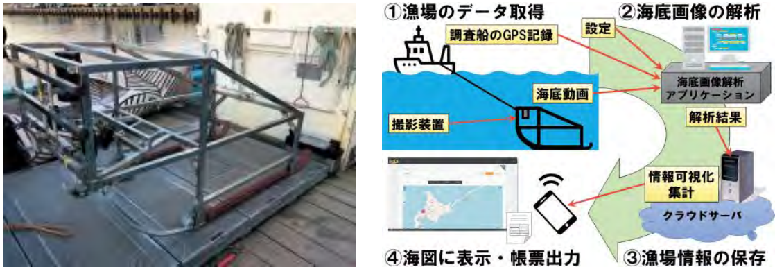
[図 3-9] けん引式撮影装置（左図）とホタテガイ漁場可視化システムの概要図（右図）
