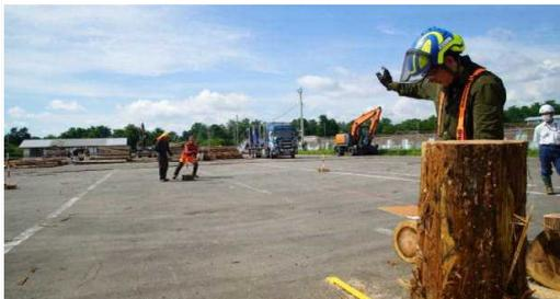
伐倒方向のずれを、ボードと水系で計測
