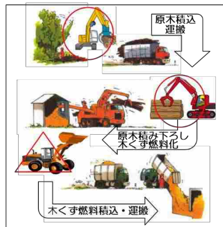
図 5.2 燃料材の供給システム
