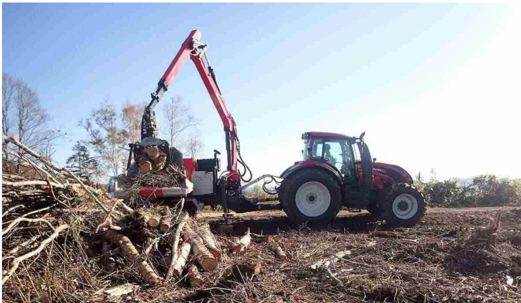
写真 3.30 トラクターPTO 駆動牽引式チップパー機
