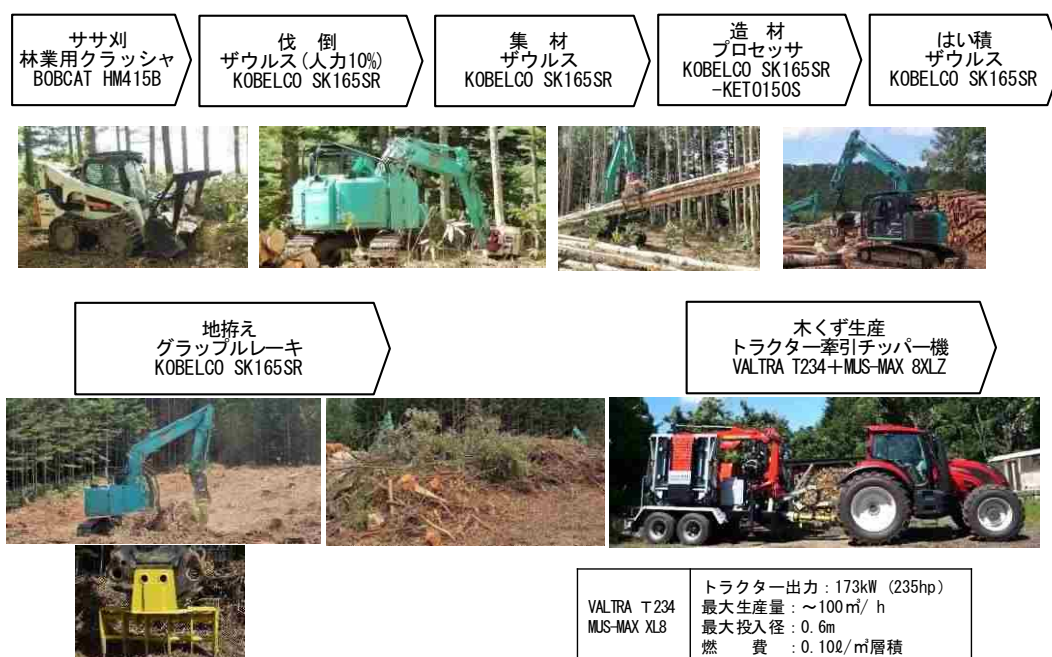
図 3.5 道北地区（上川町）における作業システム
