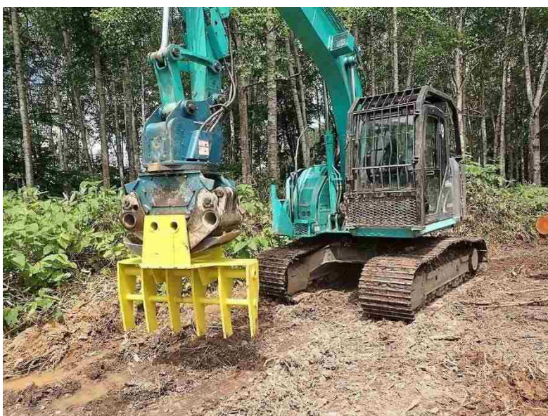
写真 3.22 グラップルで握り使用する大型レーキ
