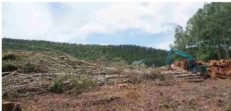
写真 3.15 狭い土場における造材（針葉樹先行、最後に枝条の多い広葉樹）
