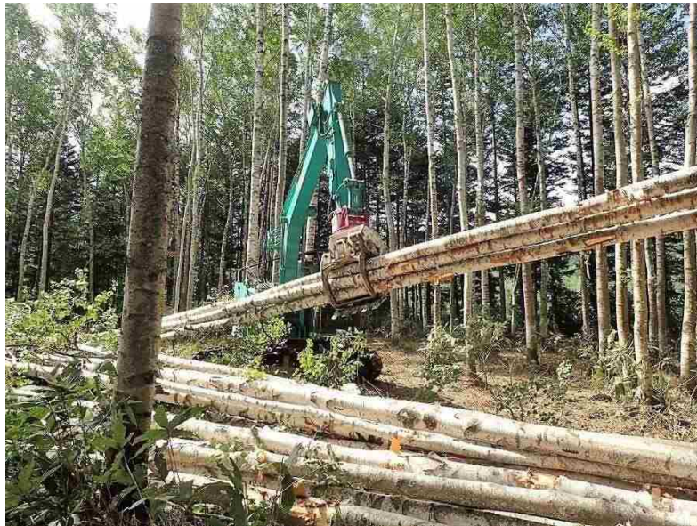
写真 3.14 グラップルによる順送り様式の効率良い集材
