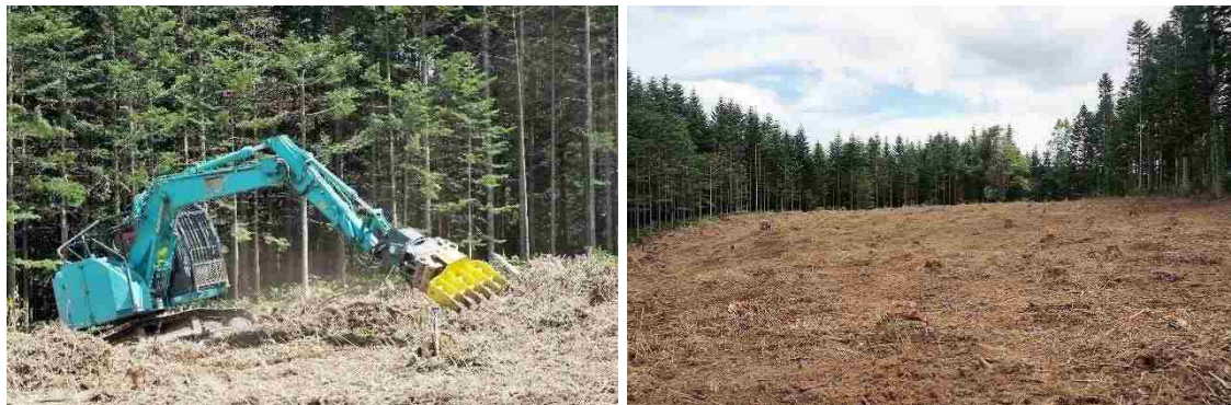
写真 3.16 グラップル大型レーキによる地拵え
