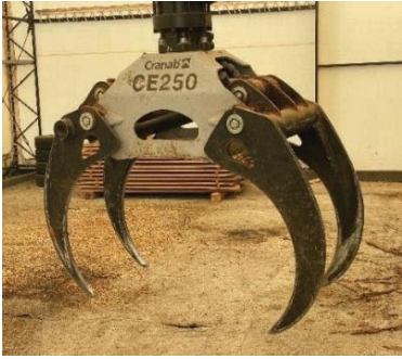
燃料材用のグラップル 爪の先端が分離しているので、土砂を落としやすい
