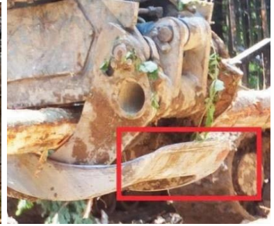
通常の林業用グラップル 爪の先端がつながっているため、土砂を落としにくい
