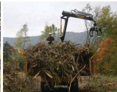
バイオマス対応型フォワーダ 積載前：荷台をスライドさせて荷箱の幅を広げる 積載後：あおりをたたみ枝条を圧縮する
