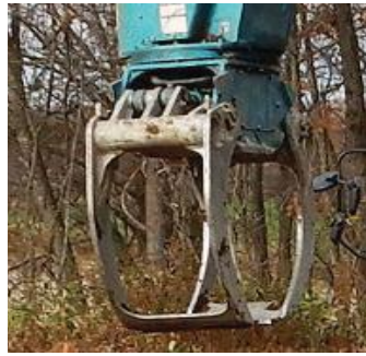
通常の林業用グラップル 爪の先端がつながっているため、土砂を落としにくい
