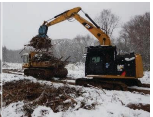
グラップル用レーキ ② なるべくお金をかけずに工夫している(枝条収集用に自作)
