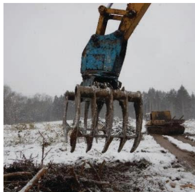
グラップル用レーキ ② なるべくお金をかけずに工夫している(枝条収集用に自作)
