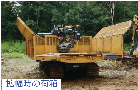
バイオマス対応型フォワーダ 積載前：荷台をスライドさせて荷箱の幅を広げる 積載後：あおりをたたみ枝条を圧縮する
