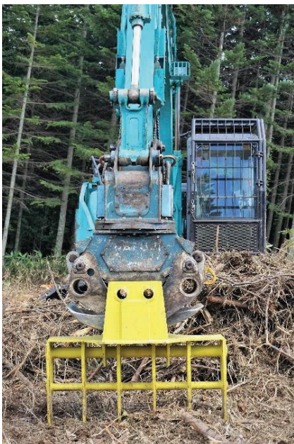
グラップル用レーキ ① 土砂が混入しないように枝条だけをかき集める
