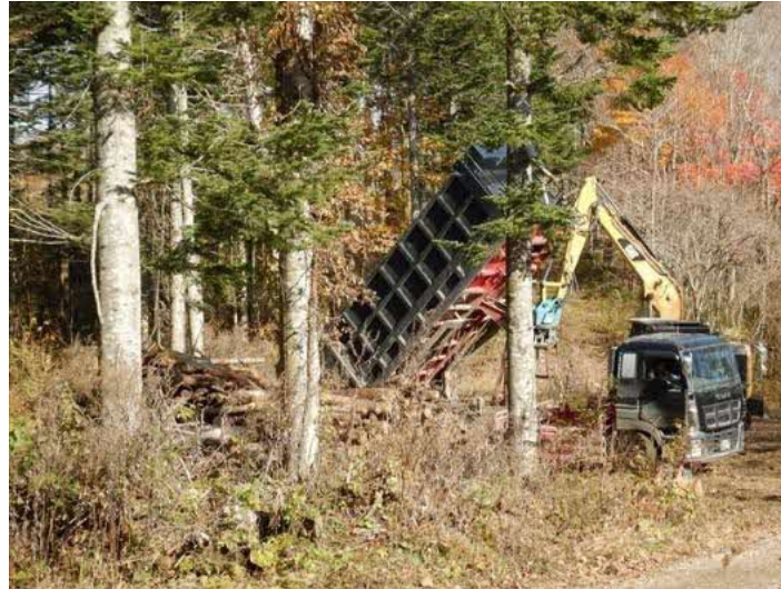
写真 3.21 分散する未利用材を山土場に集積（グラ 312E、ダンプ 30 m 3 積載可能）
