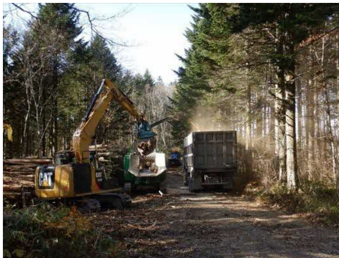
写真 3.23 グラップル（312E）でチップー機に未利用材を投入
