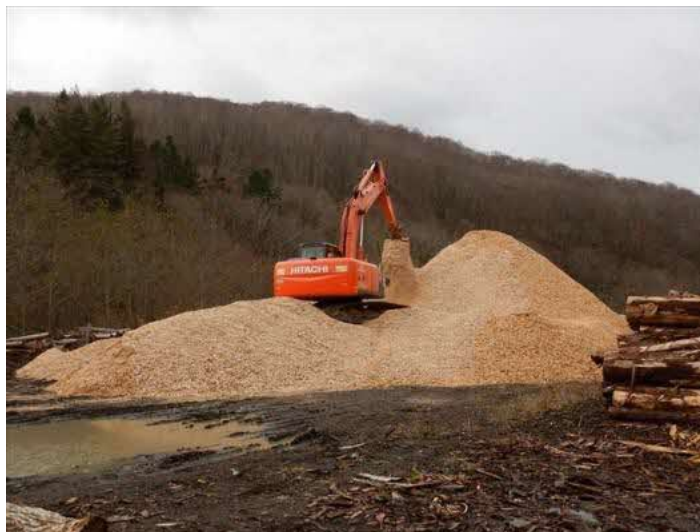
写真 3.29 バックホウ (ZAXIS200) で木くず燃料を積み上げる
