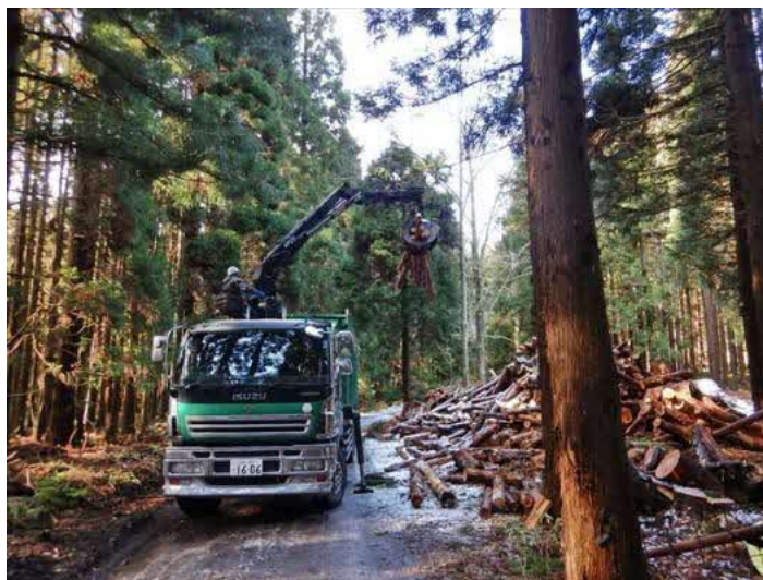
写真 3.35 ファームダンプ（30 m 3 積載可能）搭載のグラップルで積込
