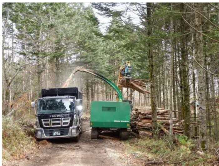
写真 3.24 生産した木くず燃料をファームダンプ（30 m 3 積載可能）に直接投入
