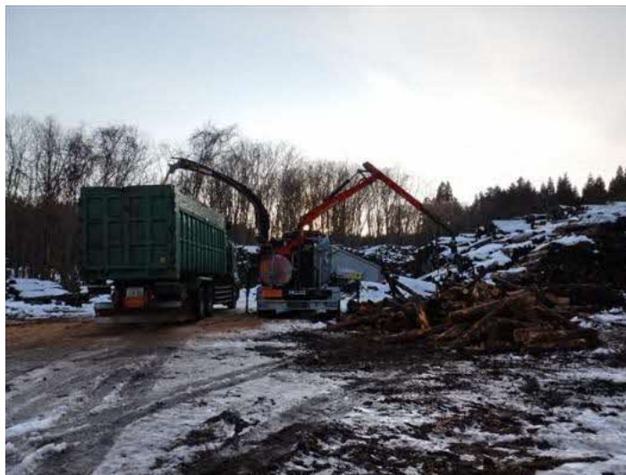
写真 3.43 ファームダンプに直接投入
