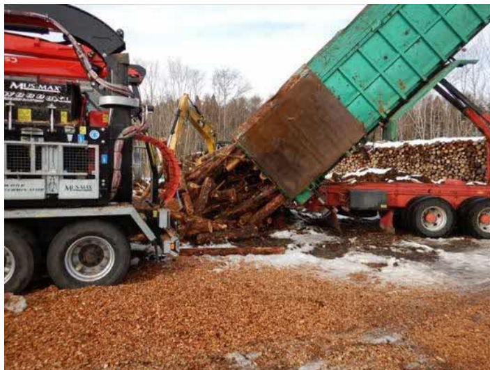
写真 3.39 未利用材の荷下ろし
