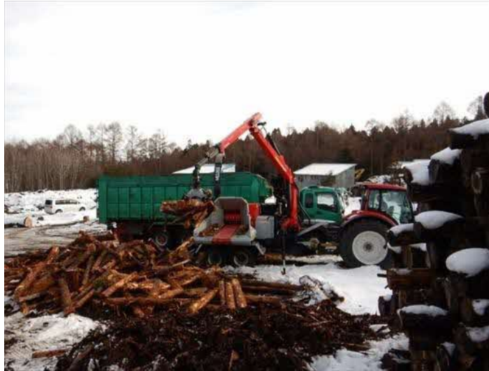
写真 3.42 チッパー機に搭載のグラップルで材を投入
