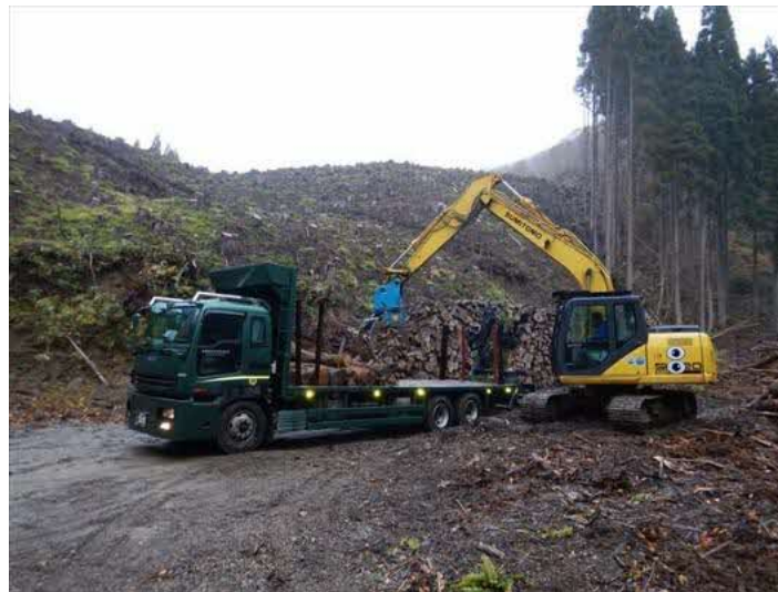
写真 3.6 未利用材の積み込み作業（SH120 使用）
