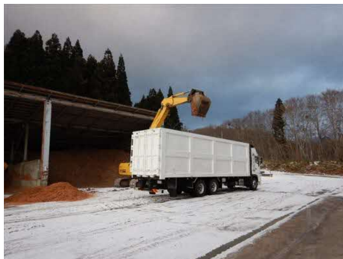
写真 3.15 バックホウ（SH200）を用いてファームダンプ（52 m 3 積載可能）に積込
