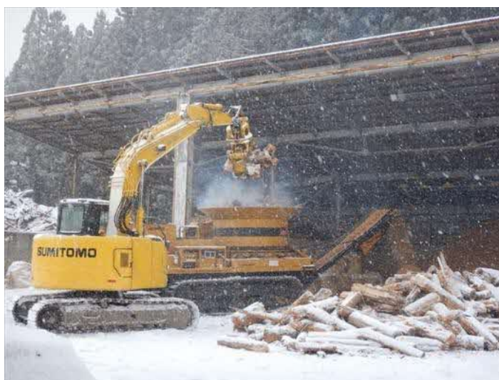
写真 3.13 グラップル（H135X3B）でチップパー機（MC6000）に未利用材を投入
