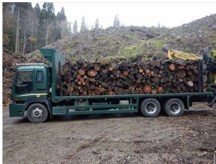
写真 3.7 施業地を出発する運搬車（20 m 3 積載可能）
