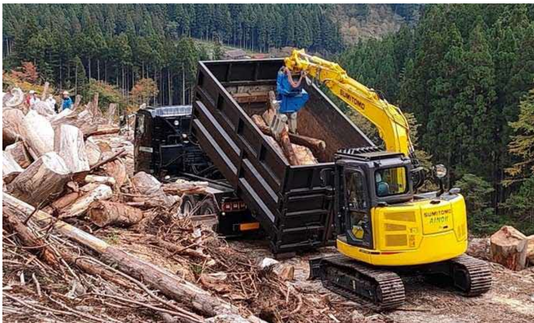
図 68 グラップル(バケット容量 0.25\text{m}^3 )とアームロールダンプでの林地未利用材集荷
