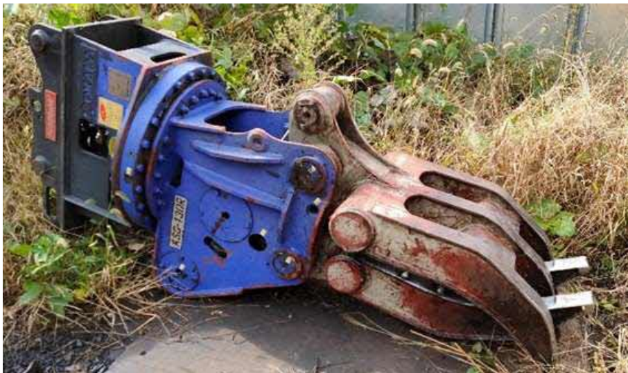
図 65 林地未利用材をチップーへ投入する際に使用するアタッチメント
