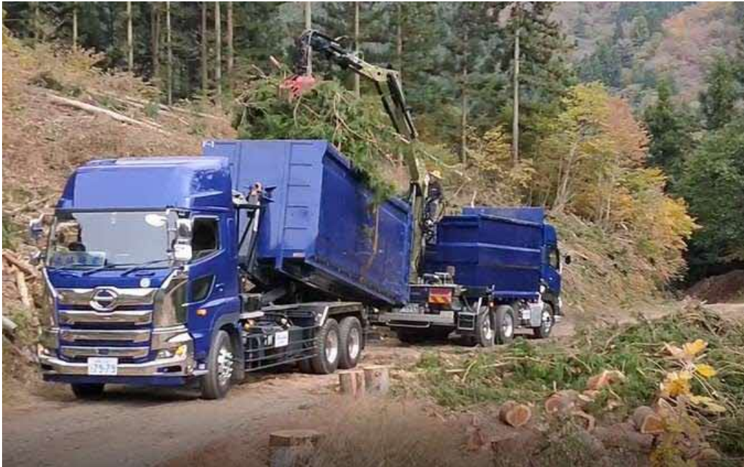
図 67 グラップル付トラックとアームロールダンプでの林地未利用材集荷
