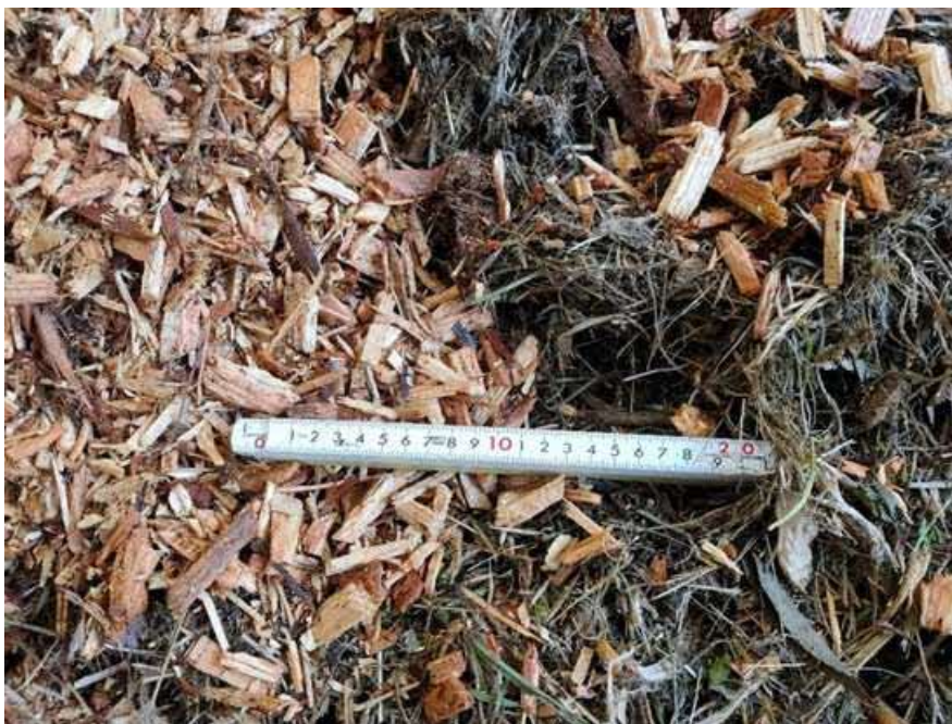
図 62 使用している木質バイオマス燃料（左：切削チップ、右：破碎チップ）
