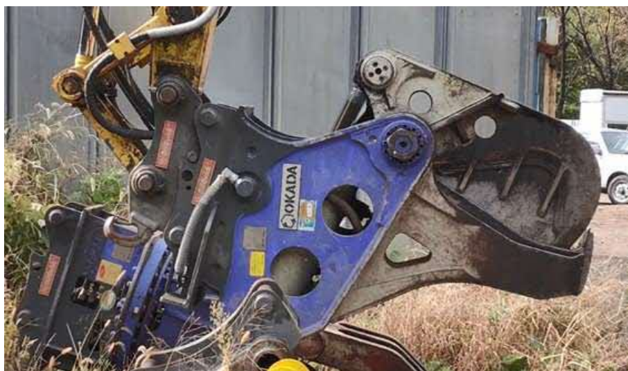
図 66 大径材を割る際に使用するアタッチメント
