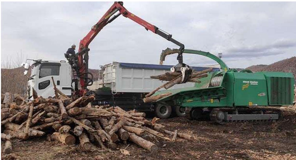
図 37 グラップル付ダンプでのチップ製造・積込
