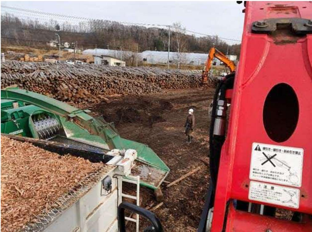
図 40 グラップル付ダンプのキャビンからの見たチッパーの投入コンベア
