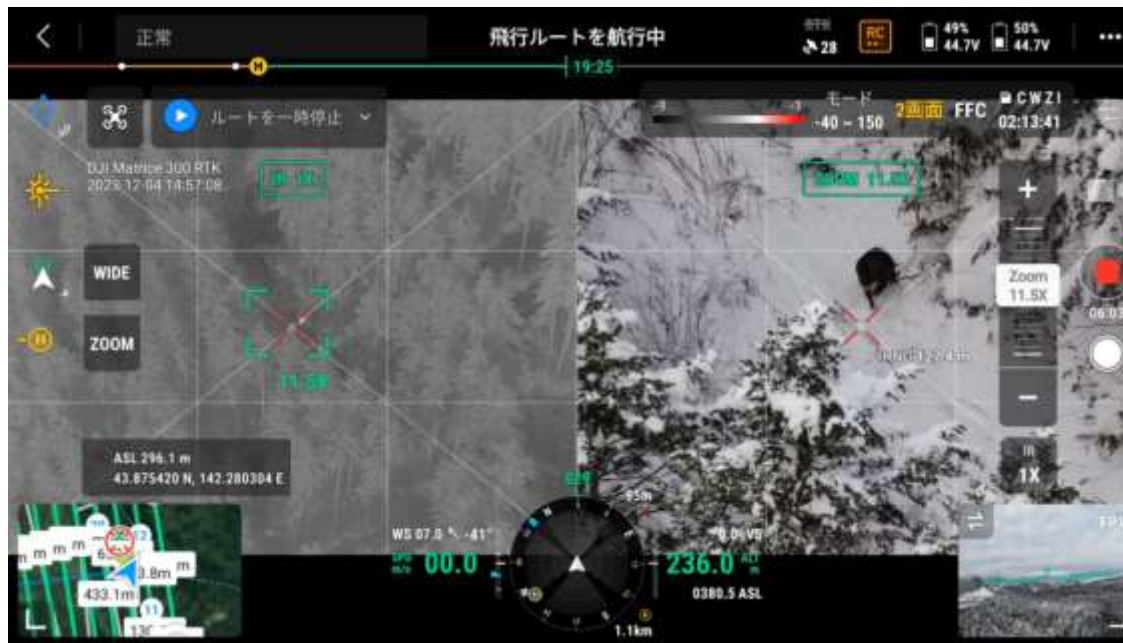
上：熱源を発見した直後の画面 下：可視カメラをズームして確認したエゾシカ 写真 6-3-6 サーマルカメラで発見した常緑針葉樹林付近のエゾシカ
