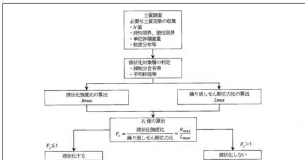
図-3.8.1 液状化判定の基本的なフロー
