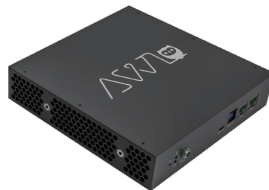
AWL(株)が独自に開発したエッジデバイス「AWLBOX」。既設の防犯カメラをAI化し、ビデオマネジメントシステム(VMS)+AIカメラ機能によって店舗オペレーションに最適なソリューションを提供する
