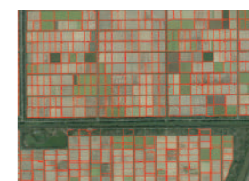
2022年4月、AIによる農地のポリゴン自動生成技術の特許を取得。従来は人の手で作成していたポリゴンを大量に自動生成できる
