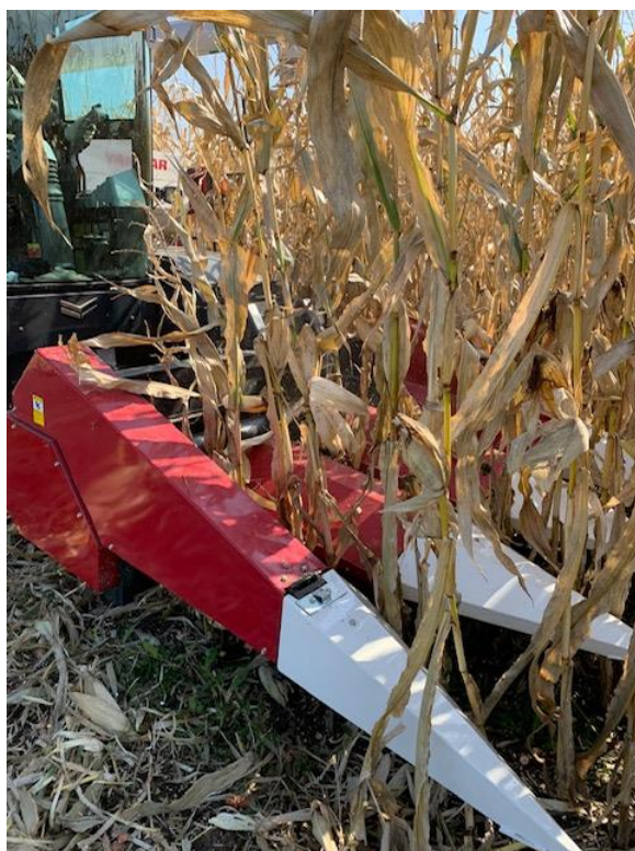
写真 汎用コンバインの子実用トウモロコシ収穫 子実コーンヘッダを装着
