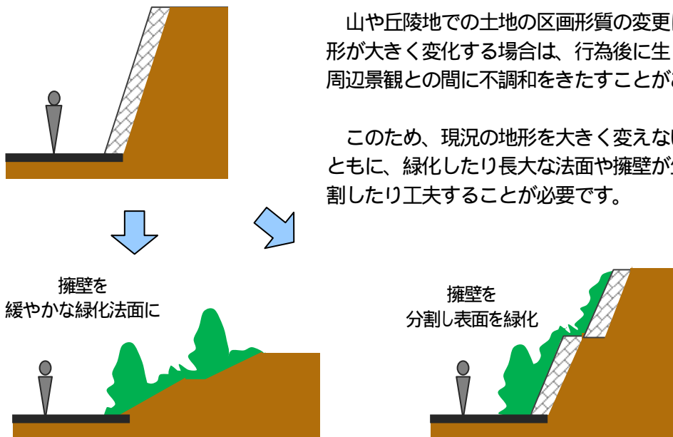
法面・擁壁を工夫した例（断面図）
